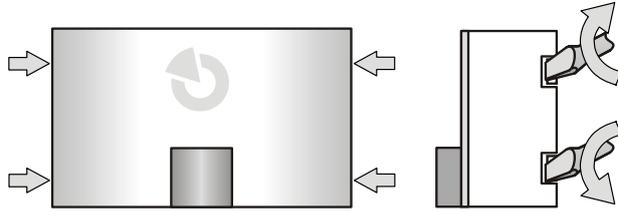
1. Die Abdeckung des Anzeigemoduls durch Lösen der vier Klinken mit Hilfe eines geeigneten flachen Schraubendrehers (in der Pfeilrichtung drehen) öffnen.
